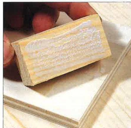
Die Leimschicht ist gleichmäßig und dünn verteilt. Sie garantiert kraftvollen Halt.
