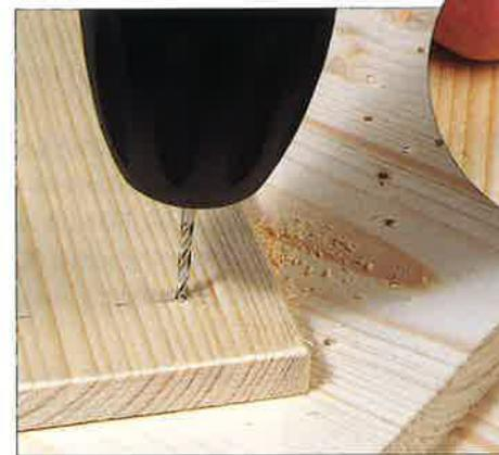
Bohrstelle markieren, mit einer Reibahle vorbohren und dann erst bohren.
