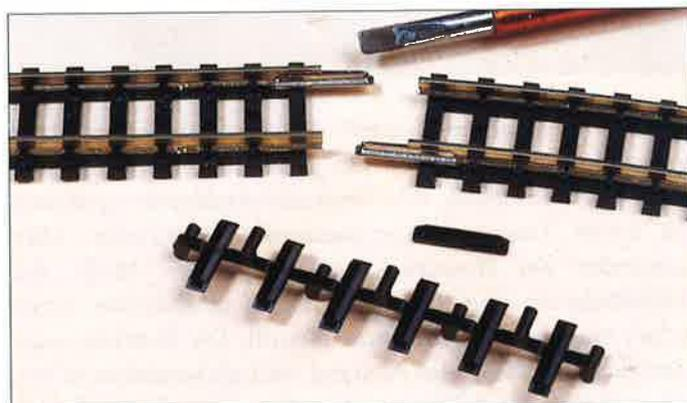
Die elektrische Trennung kann in beiden Schienenprofilen erfolgen.
