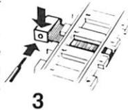
**Beachten Sie bitte, daß der Drahtanschluß auf der (anderen) Gleisseite erfolgt, die dem jeweils mit Strom zu versorgenden Schienenprofil gegenüberliegt.**
