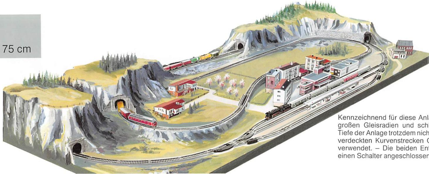
Kennzeichnend für diese Anlage ist die Verwendung von großen Gleisradien und schlanken Weichen. Damit die Tiefe der Anlage trotzdem nicht zu groß wird, wurden für die verdeckten Kurvenstrecken Gleise mit kleinerem Radius verwendet. – Die beiden Entkopplungsgleise # sind an einen Schalter angeschlossen.
