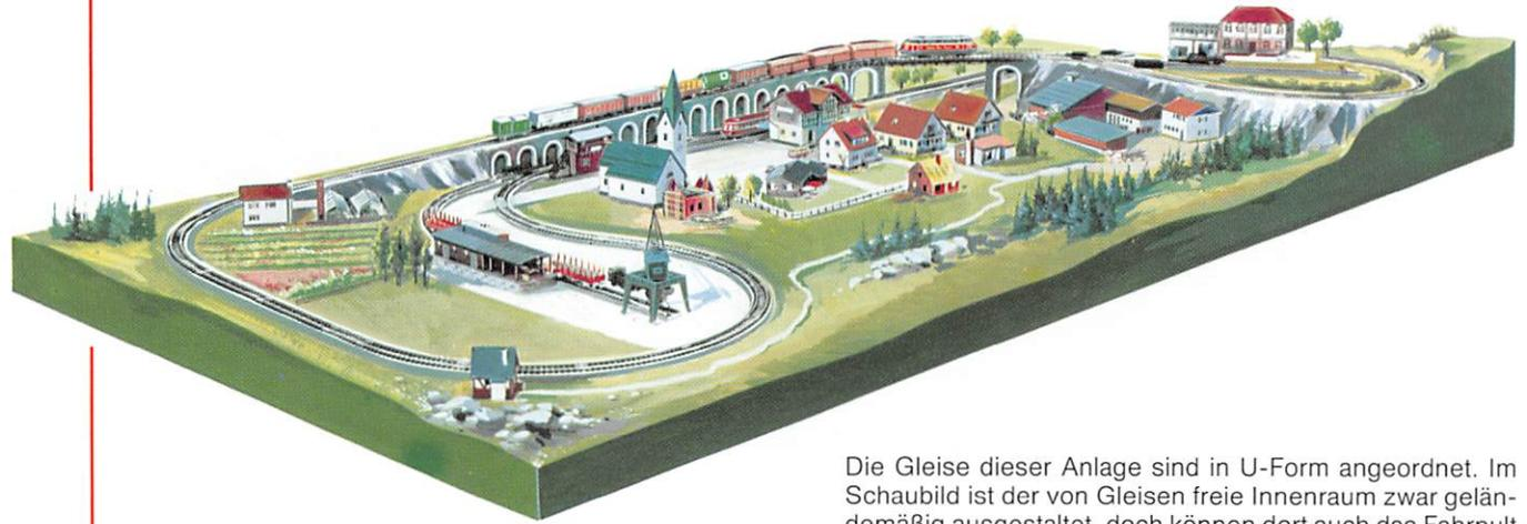
Die Gleise dieser Anlage sind in U-Form angeordnet. Im Schaubild ist der von Gleisen freie Innenraum zwar geländemäßig ausgestaltet, doch können dort auch das Fahrpult und die Schalter Platz finden, ähnlich wie es in der Gleisplan-Zeichnung der Fall ist. – Die Industriegleise und ein Bahnhofsgleis sind mit Entkopplungsgleisen # ausgestattet.
