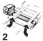
(3) Auf Drahtklemme von oben drücken, abisolierten Draht in Gleisrichtung einführen, Klemme loslassen. Anschluß ist fertig.
