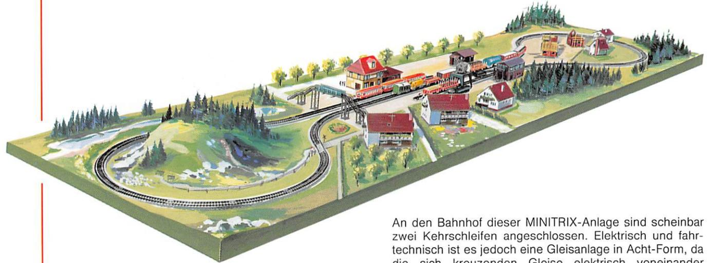
An den Bahnhof dieser MINITRIX-Anlage sind scheinbar zwei Kehrschleifen angeschlossen. Elektrisch und fahrtechnisch ist es jedoch eine Gleisanlage in Acht-Form, da die sich kreuzenden Gleise elektrisch voneinander getrennt sind (15°-Kreuzung) #
