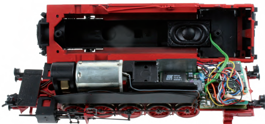
Hier geht es eng zu: Decoder 76 425, Soundmodul 32 300 und Lautsprecher 31 110 eingebaut in eine PIKO BR94.
