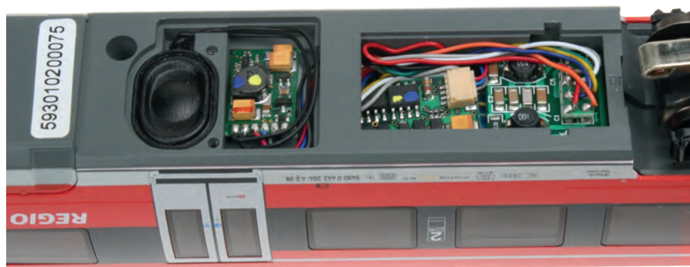
SUSI Schnittstelle in Aktion: Piko Talent 2 mit Decoder 76425, Soundmodul 32 300 und Lautsprecher 31 180
