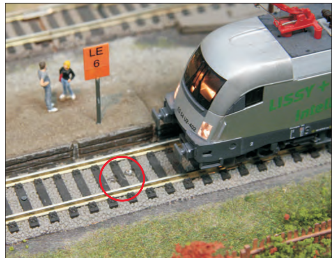
Kaum sichtbar: in das Gleis eingebaute LISSY-Empfängersensoren
