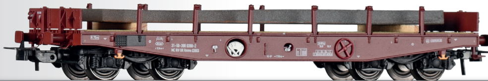
Schwerlastwagen Rmms 3960 der DR, beladen mit Stahlbrammen Flat car Rmms 3960 of the DR, with load
