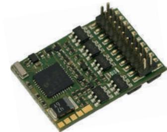
Decoder mit 22-poligem Stecker; updatefähig; Multiprotokollbetrieb möglich; Motorregelung; Unterstützung von Bremsstrecken; Lokadressen programmierbar; NMRA-kompatibel; komfortable Änderung der Betriebsparameter möglich: d.h. die Lok muss nicht geöffnet werden; Überstromschutz; RailCom \*\*
