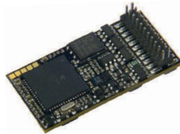
Sounddecoder mit 22-poligem Stecker; updatefähig; Multiprotokollbetrieb möglich; Motorregelung; Unterstützung von Bremsstrecken; Lokadressen programmierbar; NMRA-kompatibel; komfortable Änderung der Betriebsparameter möglich: d.h. die Lok muss nicht geöffnet werden; Überstromschutz; RailCom \*\*
