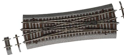
Doppelte Kreuzungsweiche DKW 15 Bauart „Baeseler“, mit außenliegenden Zungen. Länge 230 mm, Kreuzungswinkel 15°, effektiver Abzweigradius 1050 mm. Auf Grund der elektrischen Notwendigkeit dieses Kreuzungsweichtyps ab Werk polarisiert. Für den Diagonaleinbau liegen zwei D4 und ein D12 bei. Mit Bettung.
