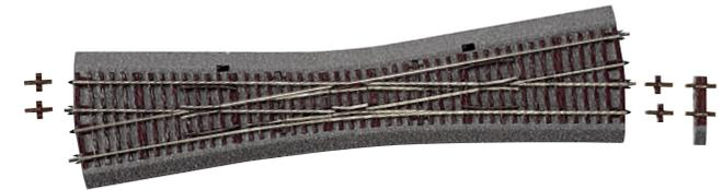
Einfache Kreuzungsweiche EKW 10, „englische“ Bauart mit innenliegenden Zungen, mit Handantrieb, Länge 345 mm, Abzweigradius 959 mm, Kreuzungswinkel 10°. Mit Bettung. Für den Längenausgleich liegen zwei Distanzstücke D2 und ein D8 bei. Passender Elektro-Antrieb 42620 (2x) oder 42624 (2x).
