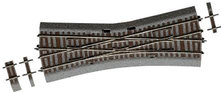
Einfache Kreuzungsweiche EKW 15, Länge 230 mm, „englische“ Bauart, mit innenliegenden Zungen. Abzweigradius 531 mm, Kreuzungswinkel 15°. Für den Diagonaleinbau liegen zwei D4 und ein D12 bei. Mit Bettung.
