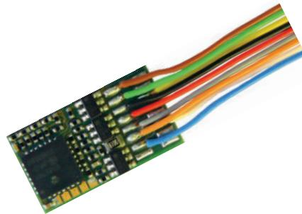
Decoder mit Litzen und 8-poligem Stecker; updatefähig; Multiprotokollbetrieb möglich; Motorregelung; Unterstützung von Bremsstrecken; Lokadressen programmierbar; NMRA-kompatibel; komfortable Änderung der Betriebsparameter möglich: d.h. die Lok muss nicht geöffnet werden; Überstromschutz; RailCom \*\*
