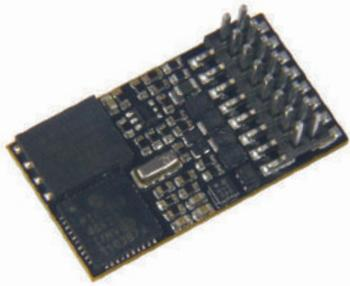
Sounddecoder mit 16-poligem Stecker; updatefähig; Multiprotokollbetrieb möglich; Motorregelung; Unterstützung von Bremsstrecken; Lokadressen programmierbar; NMRA-kompatibel; komfortable Änderung der Betriebsparameter möglich: d.h. die Lok muss nicht geöffnet werden; Überstromschutz; RailCom \*\*
