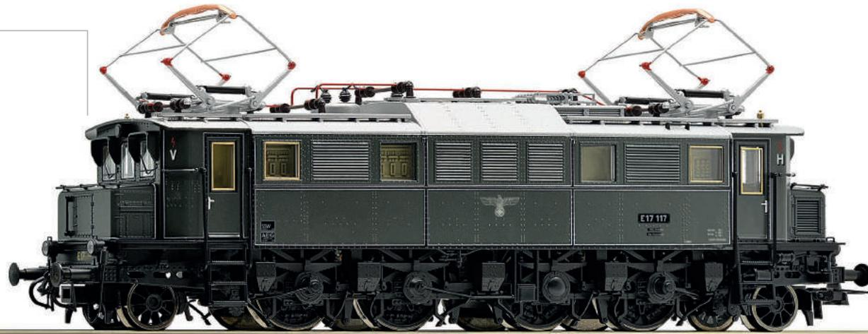
Motor mit Schwungmasse, Antrieb auf vier Achsen. Dreilicht-Spitzenbeleuchtung weiß/rot mit der Fahrtrichtung wechselnd.
