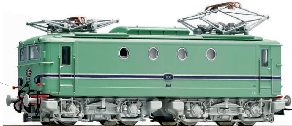
Motor mit Schwungmasse. Antrieb auf vier Achsen. Zweilicht-Spitzenbeleuchtung mit der Fahrtrichtung wechselnd.
