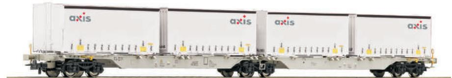
Doppeltragwagen der AAE beladen mit Axis-Wechselbrücken.
