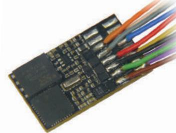
Sounddecoder mit Litzen und 8-poligem Stecker; updatefähig; Multiprotokollbetrieb möglich; Motorregelung; Unterstützung von Bremsstrecken; Lokadressen programmierbar; NMRA-kompatibel; komfortable Änderung der Betriebsparameter möglich: d.h. die Lok muss nicht geöffnet werden; Überstromschutz; RailCom \*\*
