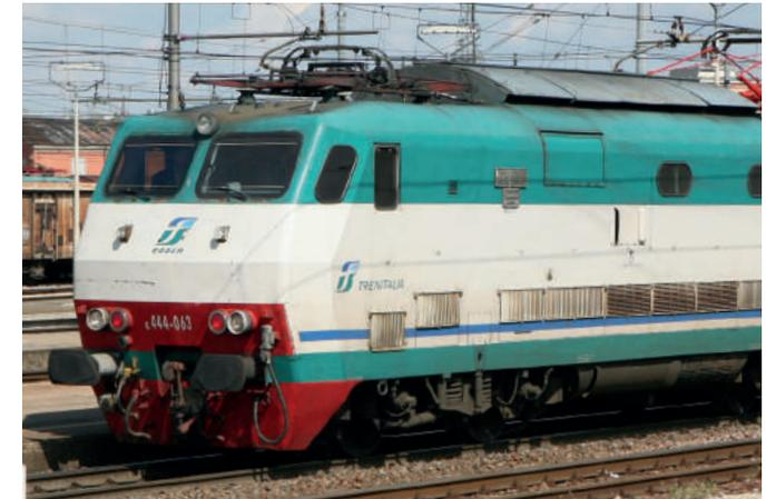
Ab dem Jahre 1970 erhielt die Italienische Staatsbahn FS insgesamt rund 117 Lokomotiven der Serie E.444. Die Loks waren dabei für den Schnellzugverkehr innerhalb Italiens vorgesehen und daher auf eine Höchstgeschwindigkeit von 200 km/h ausgelegt. Im Zeitraum von 1989 bis 1997 wurden dabei viele Lokomotiven modernisiert und in Folge dessen zur E.444R umgezeichnet. Auch optisch wurden die Lokomotiven hierbei verändert: Sie erhielten einen eckigen Kasten mit einem größeren Führerstand.
