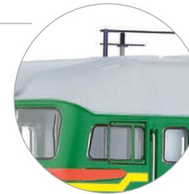
► Dachfunkantenne in Ätztechnik
