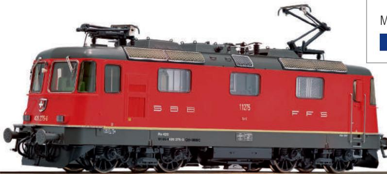
Motor mit Schwungmasse. Antrieb auf vier Achsen. LED-Spitzenbeleuchtung mit Schweizer Lichtwechsel.
