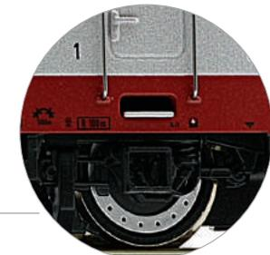
Motor mit Schwungmasse, Antrieb auf vier Achsen, Dreilight-Spitzenbeleuchtung weiß/rot mit der Fahrtrichtung wechselnd.
