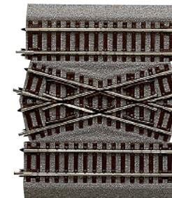
Mittelstück für doppelte Gleisverbindung DGV 15, geeignet in Verbindung mit 15°-Weichen/Kreuzungsweichen. Die kreuzenden Schienenstränge sind nicht elektrisch getrennt. Länge 115 mm. Mit Bettung.
