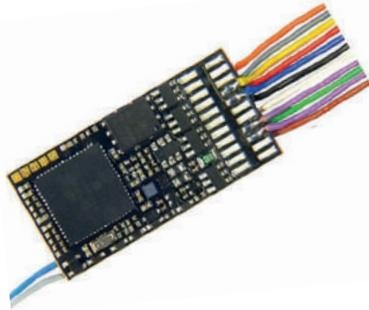
Sounddecoder mit Litzen und 8-poligem Stecker; updatefähig; Multiprotokollbetrieb möglich; Motorregelung; Unterstützung von Bremsstrecken; Lokadressen programmierbar; NMRA-kompatibel; komfortable Änderung der Betriebsparameter möglich: d.h. die Lok muss nicht geöffnet werden; Überstromschutz; RailCom \*\*
