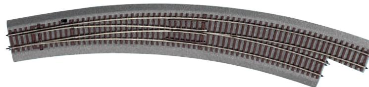
Bogenweiche rechts BWr 9/10 mit Handantrieb, Radius des Stammgleises und der Abzweigung 826,4 mm (R9)/30°.
