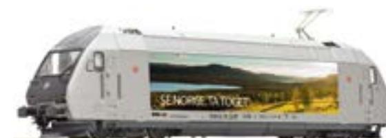
Die Lokomotiven des norwegischen Typs EL 18 sind aus der SBB Re 460 abgeleitet und wurden aufgrund der guten Schweizer Erfahrungen auch von den Norwegischen Staatsbahnen beschafft. Die 22 Maschinen sind mit zusätzlichen Einrichtungen für den Betrieb bei arktischen Temperaturen und mit Schneeräumer ausgerüstet.
