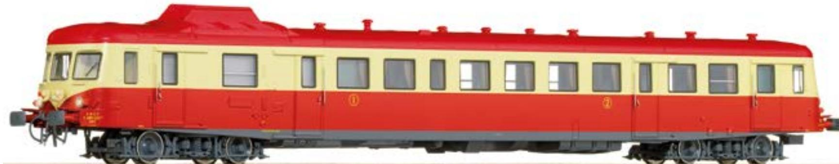
Zwischen 1957 und 1962 wurden 119 Stück dieser, für den Eil- und Schnellzugdienst konzipierten, Triebwagen gebaut. Er hatte eine Leistung von 605 kW und erreichte eine Höchstgeschwindigkeit von 120 km/h.
