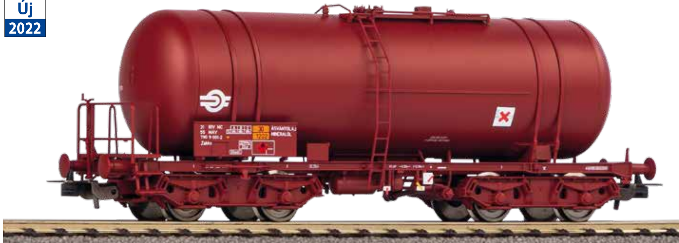
58458 Tartálykocsi fékhíddal, Zakks 406Ra, MÁV
