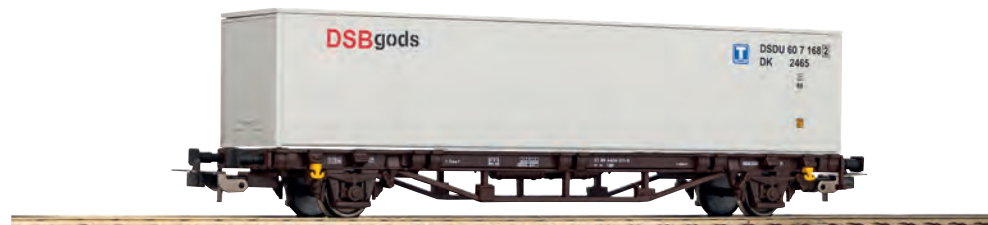
27720 DSB Containervogn litra Lgjs epoke V, læsset med en 40-fods container DSB
