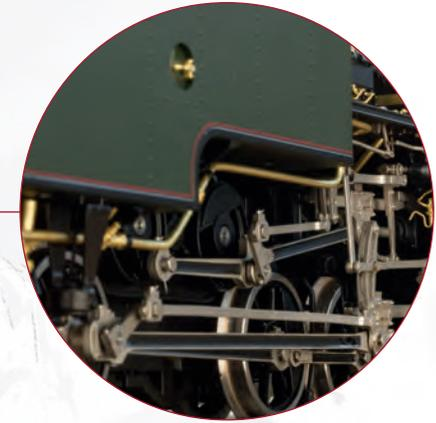
Automatische Zuschaltung Zahnradantrieb bei Betrieb auf der Zahnstange
