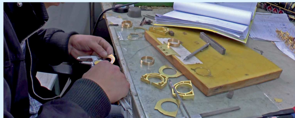
Bei der Bauweise in Messing und Handarbeit kann immer ein vollwertiger Prototyp hergestellt werden. Das wird beim Zinkdruckgussverfahren heute mit einem Vormodell aus dem 3D Drucker ersetzt.
