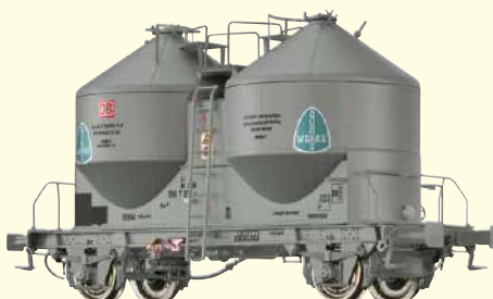
Staubbehälterwagen Ucs 909 "Quarzwerke" der DB AG Betriebs-Nr. 41 80 910 7 918-0
