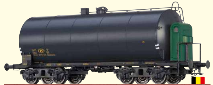
Leichtbaukesselwagen Uerdingen ZZ [P] der SNCB Betriebs-Nr. 921766
