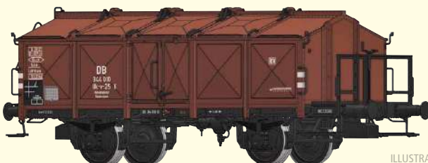
Klappdeckelwagen Uk-v 25 der DB Betriebs-Nr. 344 010
