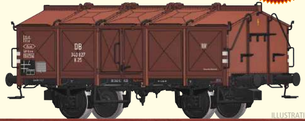
Klappdeckelwagen K 25 der DB Betriebs-Nr. 340 827
