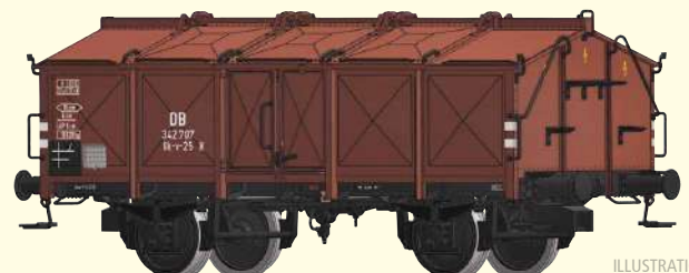
Klappdeckelwagen Uk-v 25 der DB Betriebs-Nr. 342 707
