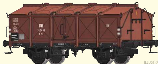
Klappdeckelwagen K 25 der DB Betriebs-Nr. 340 663
