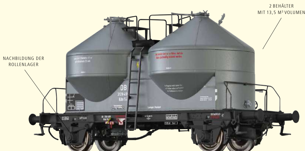
Staubbehälterwagen Kds 54 der DB Betriebs-Nr. 359 490
