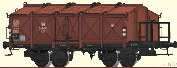
Klappdeckelwagen K 25 der DB Betriebs-Nr. 340 418
