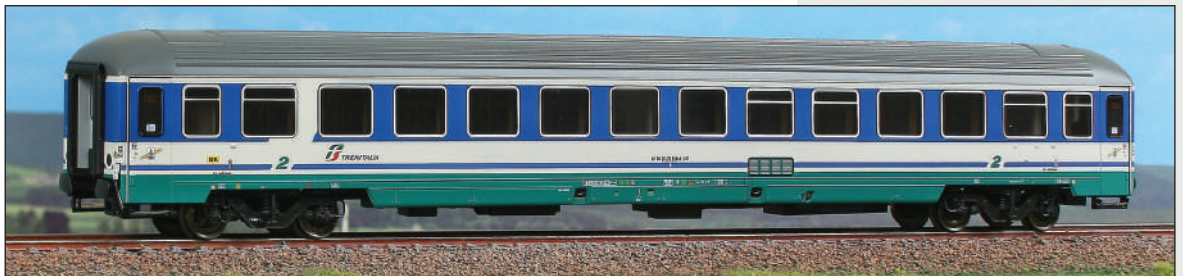
Carrozza UIC-X di 2ª classe Tipo 2000R "Giubileo" in livrea XMPR con logo "Trenitalia" rosso/verde e tetto cannellato. Type UIC-X 2000R "Giubileo" 2 nd class car, XMPR livery with ribbed roof. Typ UIC-X 2000R "Giubileo" Wagen 2.Kl. der Trenitalia, XMPR Lackierung mit gewelt Dach.
