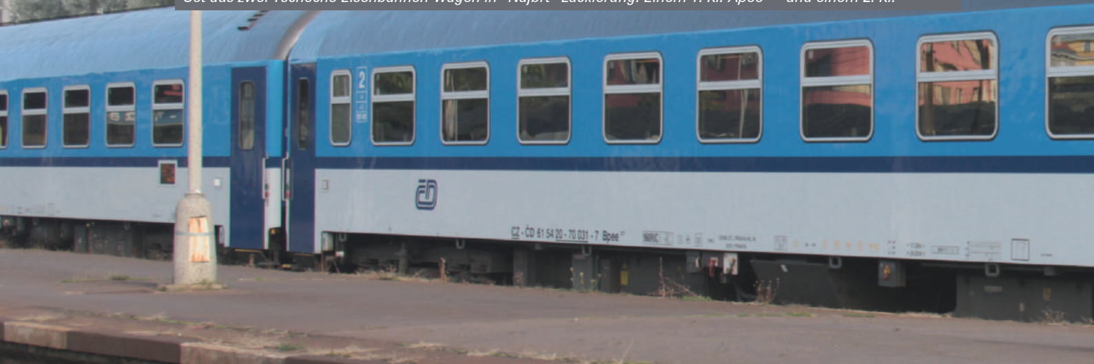
Set di due carrozze delle Ferrovie Ceche in livrea "Najbrt", una di 1 a classe Apee 139 e una di 2 a classe Bpee 237 Set of two Czech Railways cars, 1 st class Apee 139 and 2 nd class Bpee 237 in "Najbrt" livery. Set aus zwei Tscheche Eisenbahnen Wagen in "Najbrt" Lackierung. Einem 1. Kl. Apee 139 und einem 2. Kl.
