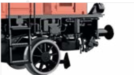
Aggregate und Leitungen freistehend ausgeführt
