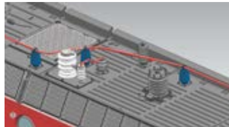
Neuer Hauptschalter und Primärspannungswandler
