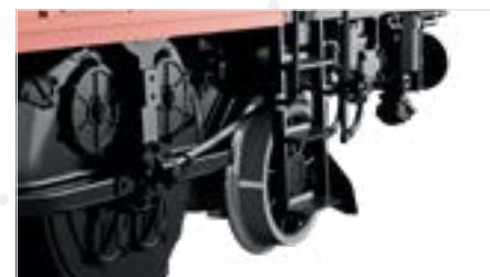
Kurbelwelle des Sicherheitsapparats extra angesteckt
