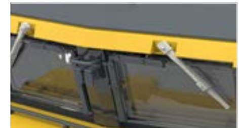
Angesteckte Scheibenwischer und Steckdosen
