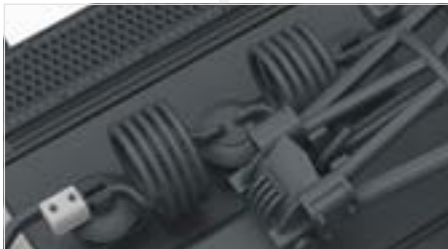
Störstromfilter aus feinstem Metalldraht
