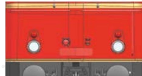
Separat angesetzte Steckdosen und Betriebsnummer
