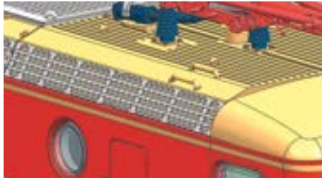
Separate Griffstangen und vorbildgerechte Lüftergitter aus Ätzblech an der Dachschräge
