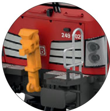
La Vectron avec plate-forme de manœuvre supplémentaire et imitation de l'attelage automatique
