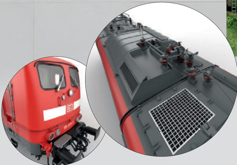
La 151 070-0 en modèle réduit avec grille d'aération décalée, câblage conforme à l'original, disjoncteur et long marchepied à l'avant
