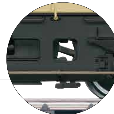
Kettenantrieb wie im Vorbild über bewegliche Kettenglieder
