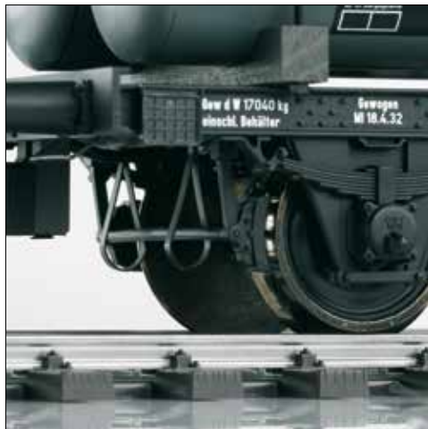
Detailliert ausgeführt, die zusätzlichen Bremssteile
