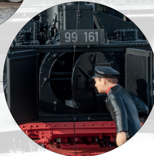
Ganz wie am Vorbild muss auch am Modell erst die Verkleidung geöffnet werden um freien Zugang zur Rauchkammertür zu haben
