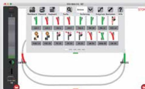
So können verschiedene Bedienelemente wie Magnetartikel, Lokliste oder die Fahrpläne für die Loks durch intuitives Wischen über das Display auf- und wieder zugeklappt werden.
