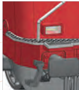
■ Variante mit Aufstieg und Griffstange
