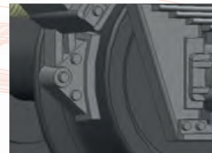
■ Bremsbacken auf Radlaufebene
