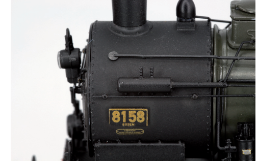
Erstmals Überhitzerautomat an Epoche -I-Lok
