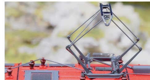
Heb- und senkbarer Stromabnehmer
