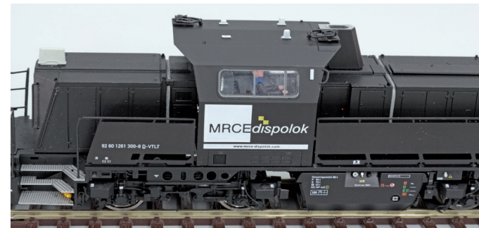
Kleinteile aus Messing und Kunststoff separat angesetzt
