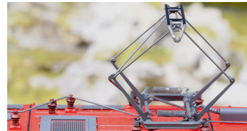
Heb- und senkbarer Stromabnehmer
