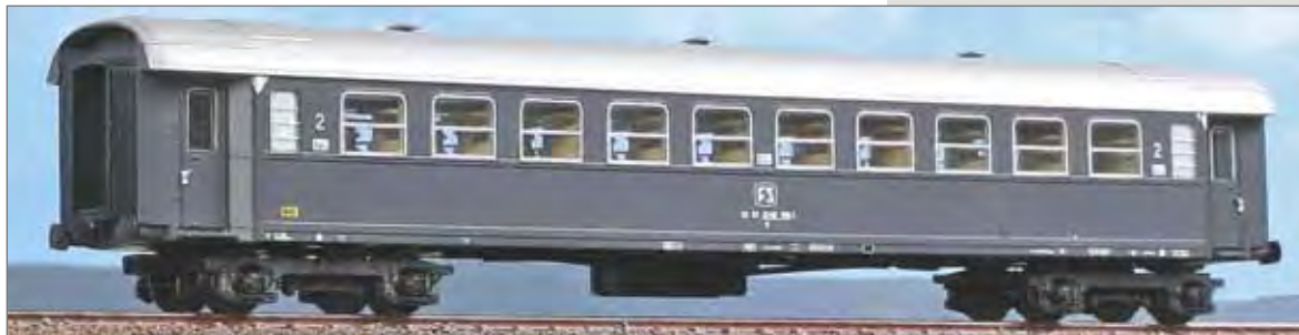
Carrozza di 2ª classe tipo 1956 R (Bz 30.800) in livrea grigio ardesia con finestrini Klein e carrelli 27, altra numerazione con tre loghi fumatori/non fumatori.
