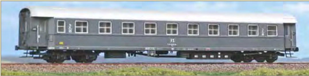
Carrozza cuccette Tipo 1959 - 2a classe, livrea grigio ardesia, carrelli 24. Couchette car Typ 1959, second class gray livery, bogies FS 24. Typ 1959 2. Klasse Liegewagen, schiefergraue Lackierung, FS24 Drehgestelle.
