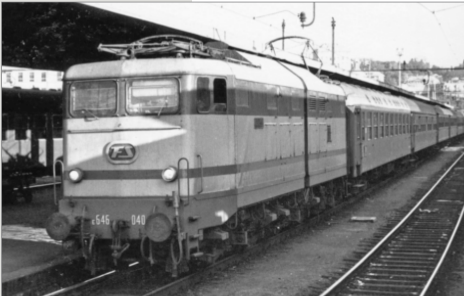
Locomotiva elettrica E.646.040, epoca IVa, senza modanature, scalette larghe, livrea con banda verde uniforme stretta. Electric locomotive E.646.040 in ep. IV status with wide ladder, smooth sides and narrow green ribbon. E-Lok E.646.040, Epoche IVa, ohne Zierleisten, breite Aufstiegsleitern, Farbgebung mit schmalem gleichmäßigen grünen Streifen.
