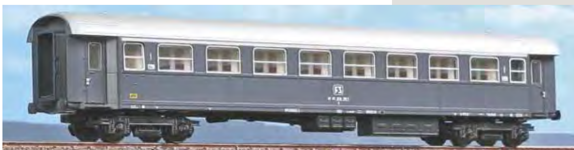
Carrozza di 1ª classe Tipo 1955R (Az 20.500) in livrea grigio ardesia con finestrini Klein e carrelli 24. 1 st class Type 1955R FS car, slate grey livery, type 24 bogies.
