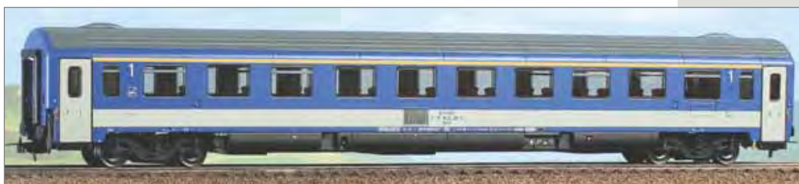
Carrozza di 1ª classe a salone Tipo EuroCity delle MÁV (Ferrovie Statali Ungheresi). Livrea azzurra e bianca senza logo. 1 st class Type EuroCity salon passenger car of the MÁV (Hungarian State Railways). Light blue and white livery, no logo. 1.Klasse Typ Eurocity Großraumwagen der MÁV. Blauweiße Lackierung ohne Logo.
