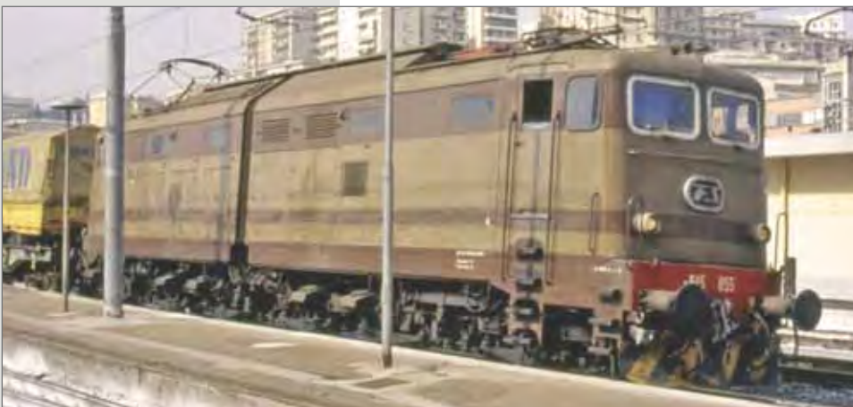
Locomotiva delle FS E.645.055 di seconda serie, nella livrea castano e Isabella con cornice dei finestrini frontali di tipo metallico. Deposito di Reggio Calabria . E.645.055 Italian Railways locomotive. Second series model, two tone brown livery, with steel front windows frame. E-Lok E.645.055 der FS, Zweite Bauserie, zweitönige braune Lackierung, Fensterrahmen aus Metall.
