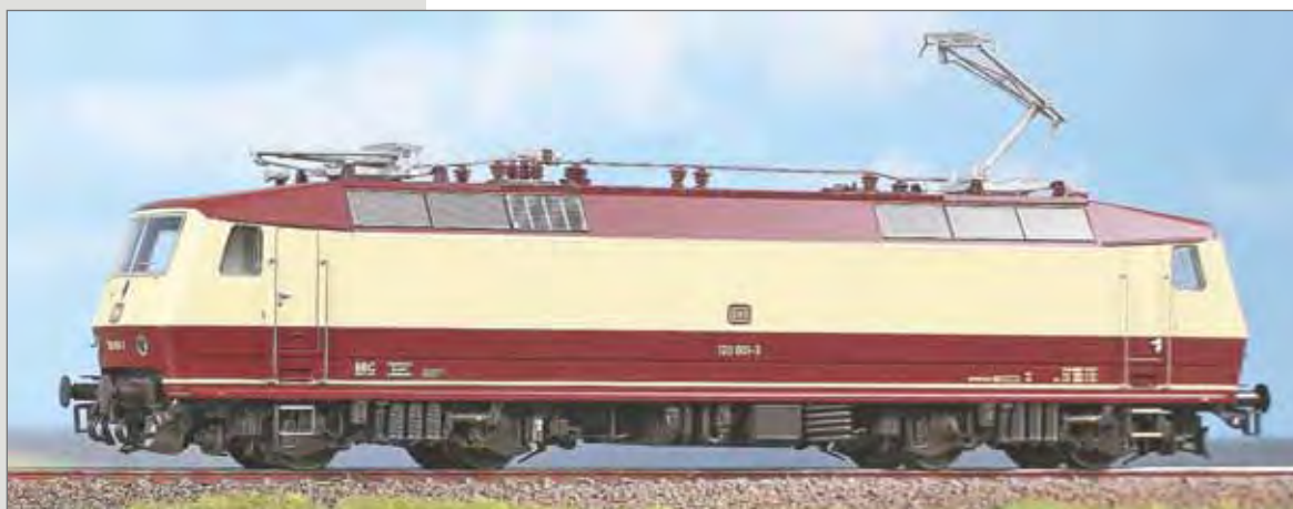
Locomotiva elettrica 120 001 della DB, allo stato d'origine, con una linea AT sul tetto e pantografi d'origine. Electric Locomotive 120 001 of the DB, as delivered, with single line wiring equipment on the roof and original pantograph. E-Lok 120 001 der DB im Ursprungszustand, mit nur einer Dachleitung und ursprünglichem Stromabnehmer.
