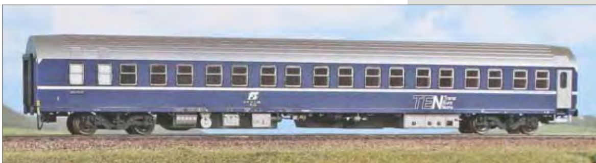
Carrozza letti FS Tipo T2s 1982 con carrelli FIAT, livrea blu con logo TEN. FS Type T2s sleeping car with FIAT bogies, blue livery, TEN logo. FS Typ T2S Schlafwagen mit FIAT Drehgestelle, blaue Lackierung, TEN-Logo.
