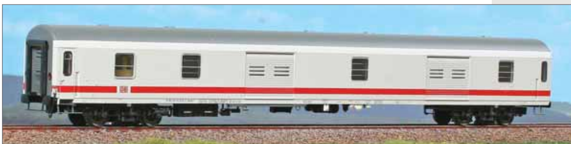
Bagagliaio Dmsdz 859 in livrea DB ICE con due porte. Dmsdz 859 baggage car, DB ICE livery, two doors. Dmsdz 859 Gepäckwagen, mit DB ICE Lackierung, zwei Türen.
